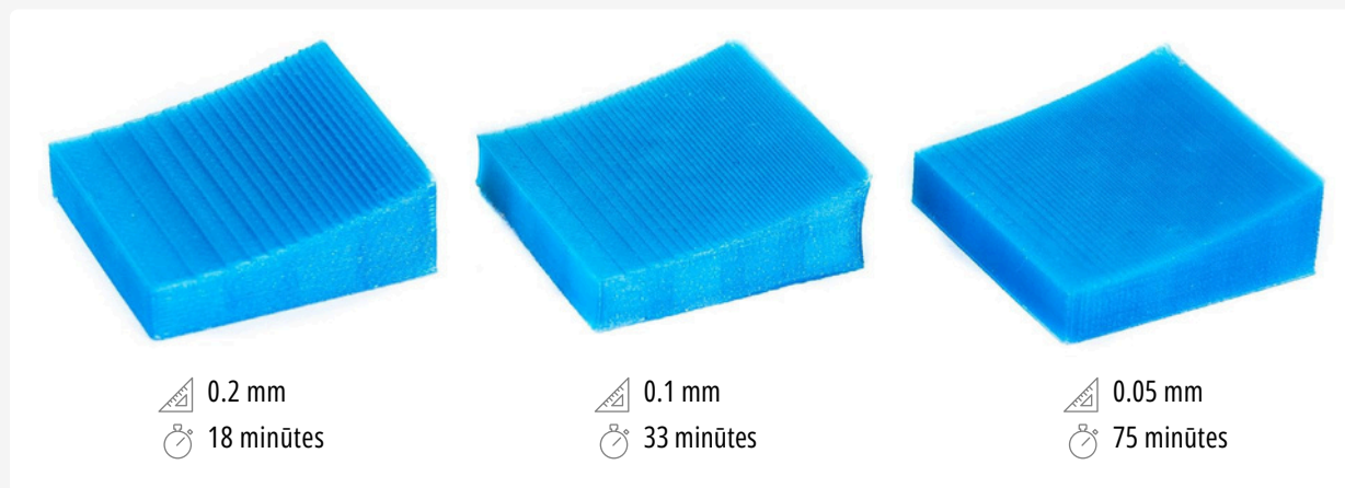
Kā slāņa augstums ietekmē objekta virsmu
